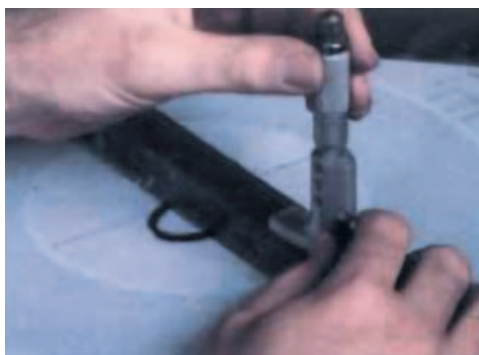
Midiendo la profundidad de la abrasión
