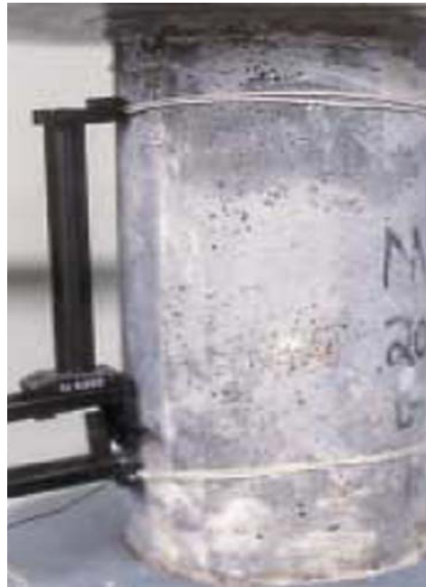
Los cilindros del material de ensayo están sujetos a compresión para determinar el cambio de longitud al fallar.
